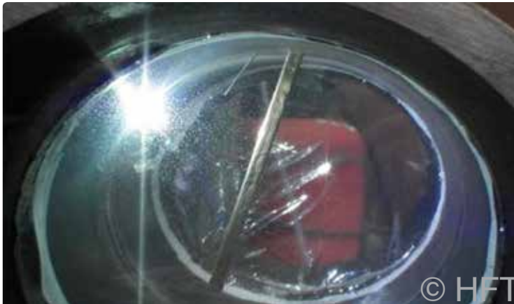
Argweld® Weld Purge Film® wasserlösliche Folie im Rohr
