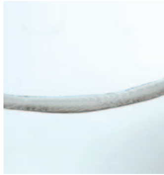
Bild 10: Belagfreie Naht mit „Cleanflow“
