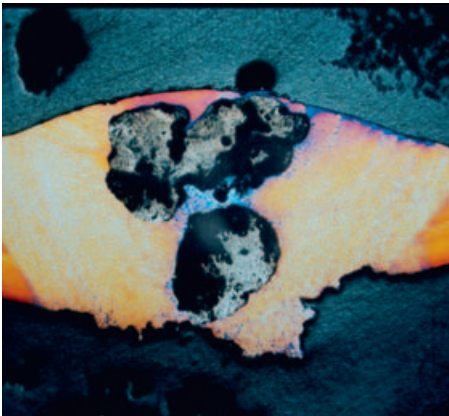
Bild 1: Fortgeschrittene Lochkorrosion im Schweißgut einer WIG-Schweißverbindung an nichtrostendem Stahl (Quelle: SLV München, Fr. Weilhammer)
