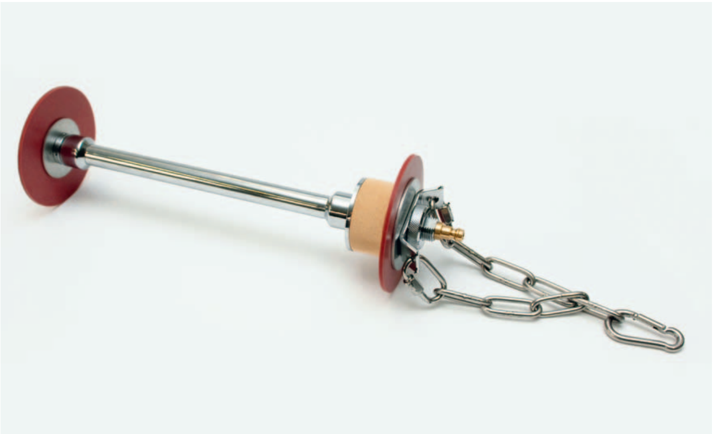
Bild 8: Beispiel einer Formiervorrichtung für gerade Rohre
