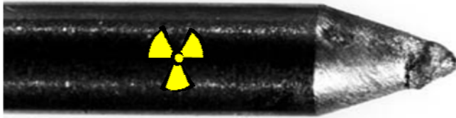
2% thorierte Elektrode nach 20 Zündungen
